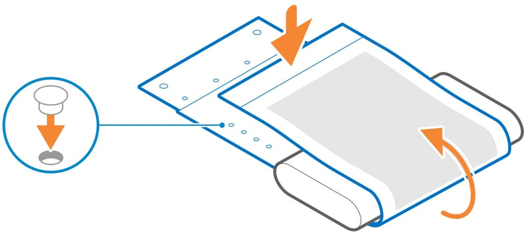
4. **NOTA:** Los orificios para tornillos del montaje de la funda del adaptador de CA están a 70 mm (2,756 pulgadas) de distancia.
