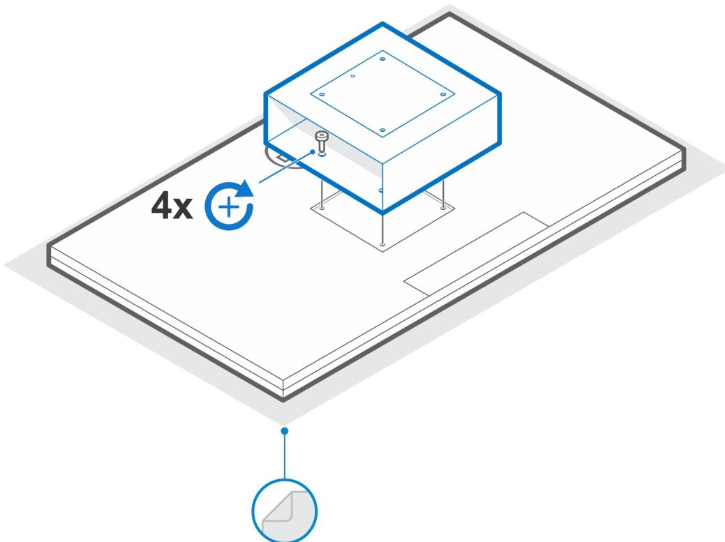
5. Deslice el sistema en el montaje de funda VESA, alineando los orificios para tornillos del montaje de funda VESA con los orificios para tornillos del sistema.
