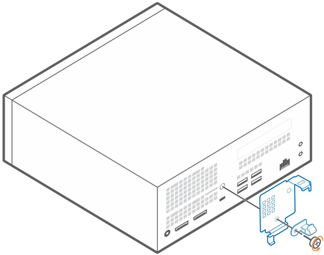
5. Pase los cables por la ranura en la cubierta de cables y conecte los cables a sus respectivos puertos.
