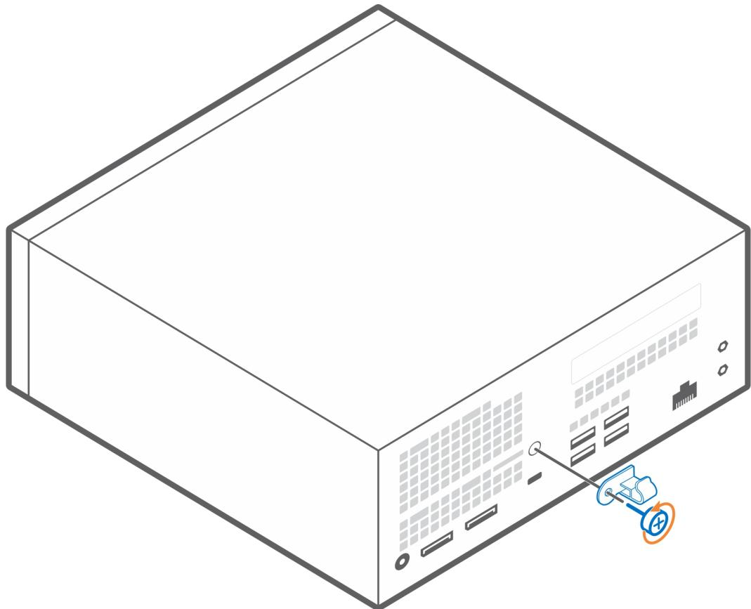
3. Alinee el soporte posterior, junto con el gancho para cables, en la parte posterior del sistema.
