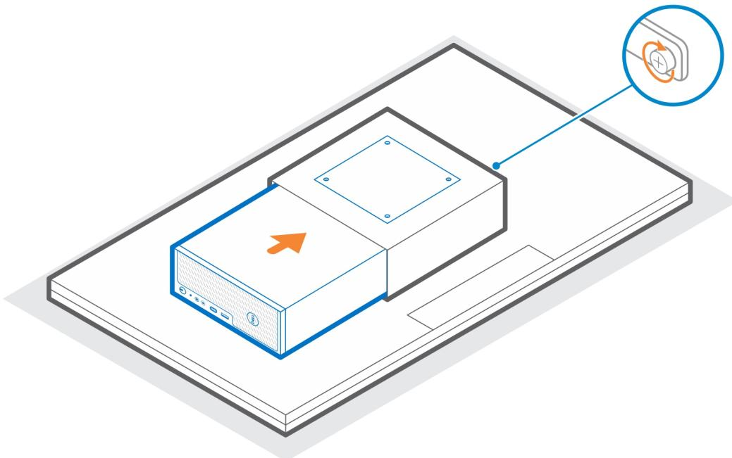
7. Alinee los orificios de los tornillos en la placa del adaptador VESA con los orificios para tornillos del montaje de funda VESA.
