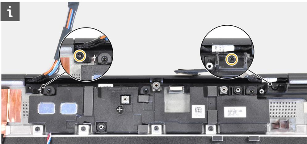
5. Bringen Sie die vier Schrauben (M2x3) zur Befestigung der mittleren Abdeckung wieder an.
