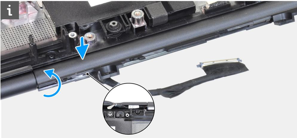
3. Drehen Sie die Scharnierabdeckung und verstauen Sie die Laschen an der mittleren Abdeckung unterhalb des Lautsprechermoduls.
