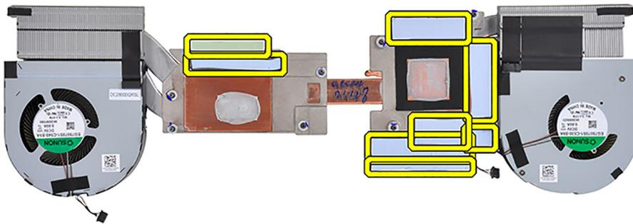
**ANMERKUNG:** Bei Computern, die mit der UMA-Grafikkarte ausgeliefert werden, werden die Kühlplatten in der linken Hälfte der Kühlkörperbaugruppe angezeigt.
