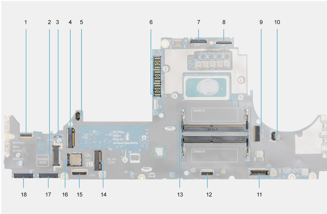
1. FFC-Anschluss für Netzschalter
