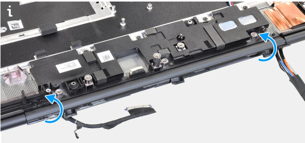
4. Richten Sie die mittlere Abdeckung an der Handballenstütze aus und setzen Sie sie auf.
