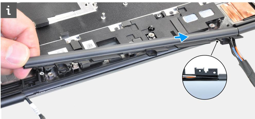
2. Drücken Sie die andere Seite der Abdeckung in die linke Bildschirmscharnierabdeckung und verstauen Sie das Bildschirmkabel in der hohlen mittleren Abdeckung.
