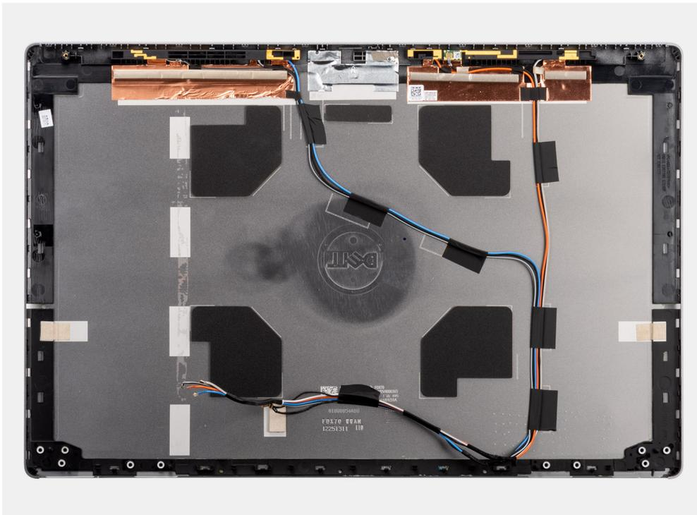
Zum Installieren der Komponenten legen Sie die hintere Bildschirmabdeckung auf einer ebenen Oberfläche ab.
