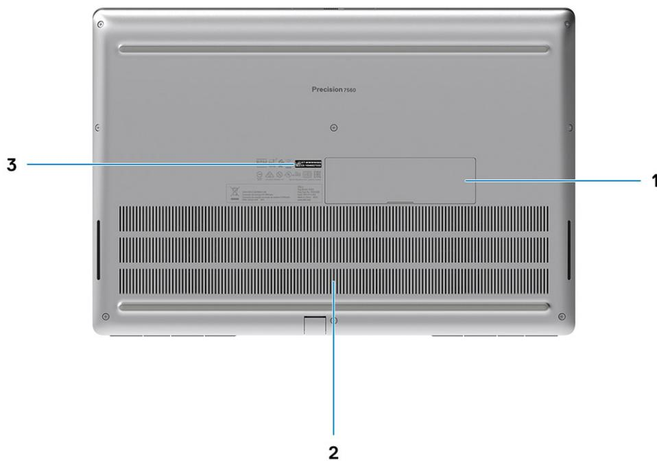
1. SSD-Laufwerkklappe (optional)
