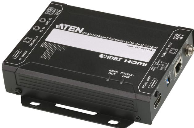
L'ATEN VE814AT est un émetteur vidéo HDBaseT pouvant transmettre les signaux HDMI jusqu'à 100 m sur un seul câble Cat 5e/6/6a ou ATEN [2L-2910](#) Cat 6. Doté de deux sorties synchrones, le VE814AT peut transmettre le signal vidéo à deux affichages distants et un sur le côté local. Cet émetteur compatible HDCP 2.2 répond aux spécifications HDMI, y compris 3D, Deep Color, au débit de données maximal de 10,2 Gbps et à la qualité vidéo 4K jusqu'à 100 m.
