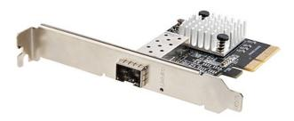
Mit dieser PCIe Netzwerkkarte können Sie die Vorteile einer verbesserten Bandbreite bei datenintensiven Anwendungen wie Multimedia-Streaming und großen Dateiübertragungen nutzen. Diese Glasfaser-NIC bietet Datenübertragungsraten von bis zu 10Gbit/s, die zur Verbesserung der Geschwindigkeit und zur Verkürzung der Ladezeiten beitragen.
