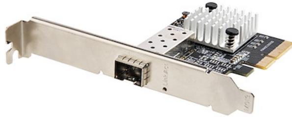
Esta tarjeta de red PCIe le permite aprovechar la mejora del ancho de banda en las aplicaciones de uso intensivo de datos, como el streaming multimedia y las transferencias de archivos de gran tamaño. Esta NIC de fibra ofrece tasas de transferencia de datos de hasta 10Gbps que mejoran la velocidad y reducen los tiempos de carga.
