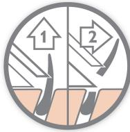
第一層刀鋒提起鬍鬚，第二層刀鋒舒適地刮除皮膚下的鬍鬚，實現順暢的完美成果。
