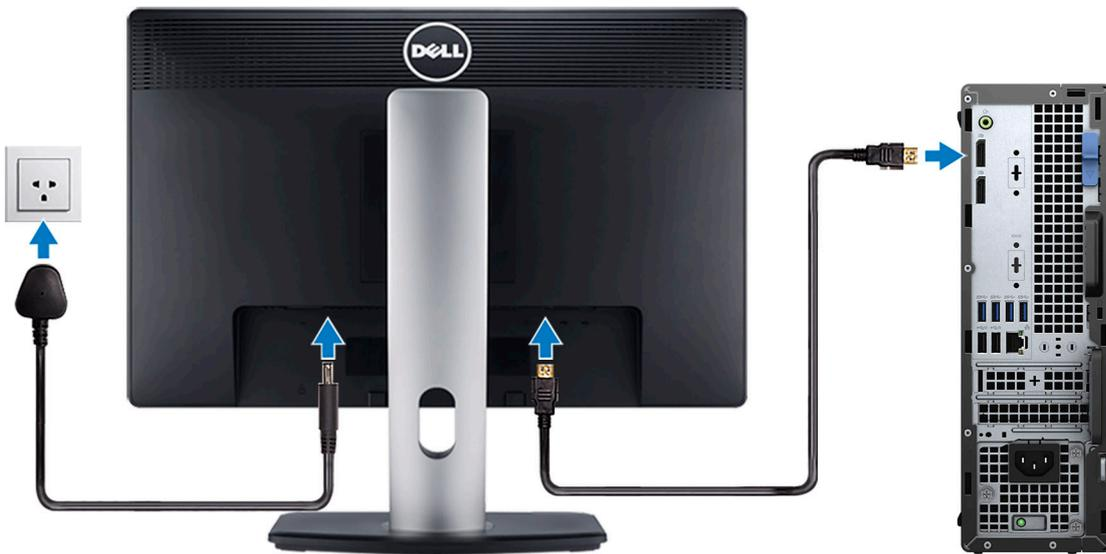
4. Schließen Sie das Stromkabel an.
