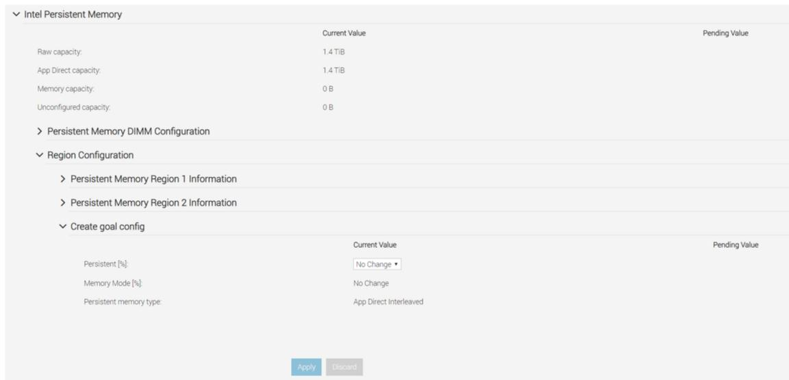
**Ilustración 10. Configuración de objetivo de DCPMM**
