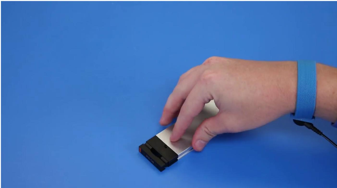
d. Faites glisser le SSD pour le sortir du logement M.2 sur le support.
