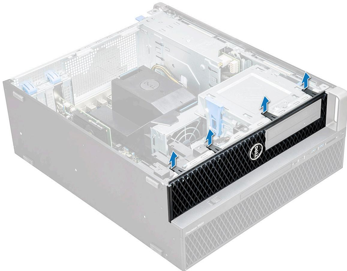
b. Faites pivoter le cadre vers l'avant, puis soulevez-le pour le retirer du système.
