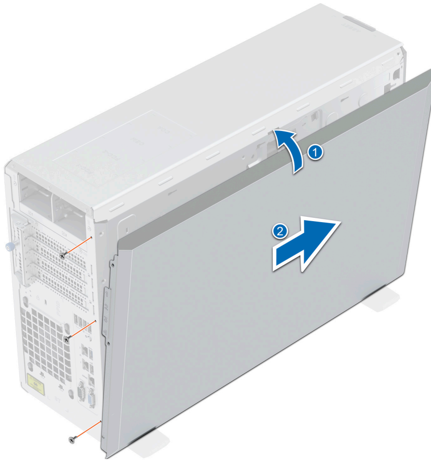
Ilustración 101. Instalación de la cubierta lateral del sistema
