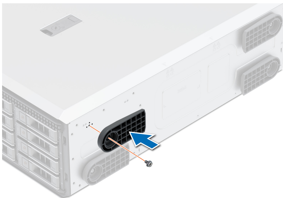
Ilustración 15. Instalación de los pies del sistema
