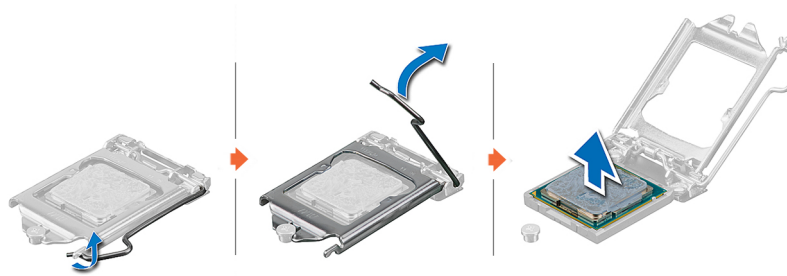
Ilustración 50. Extracción del procesador
