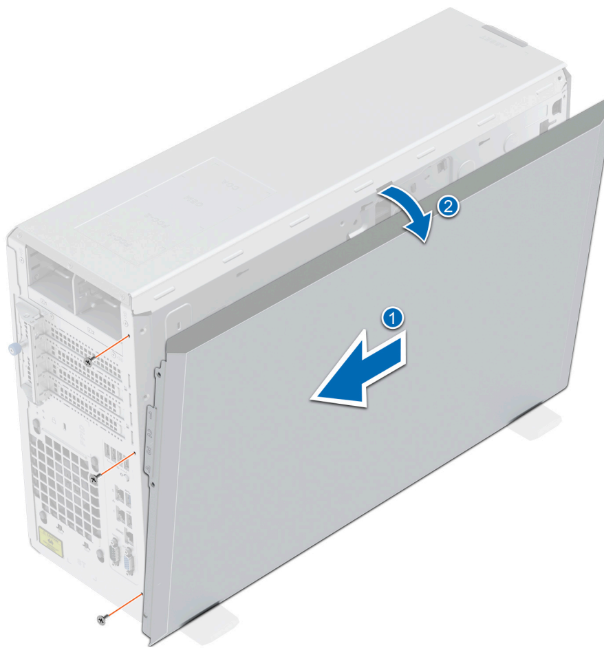
Ilustración 94. Extracción de la cubierta lateral del sistema
