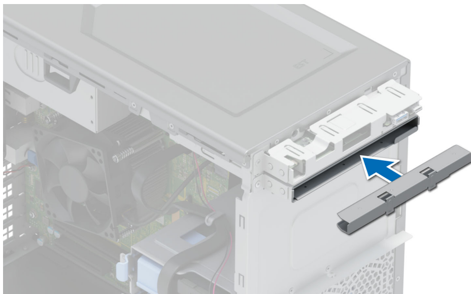
Figure 25. Installation de la plaque de recouvrement du lecteur optique dans le bâti du lecteur optique
