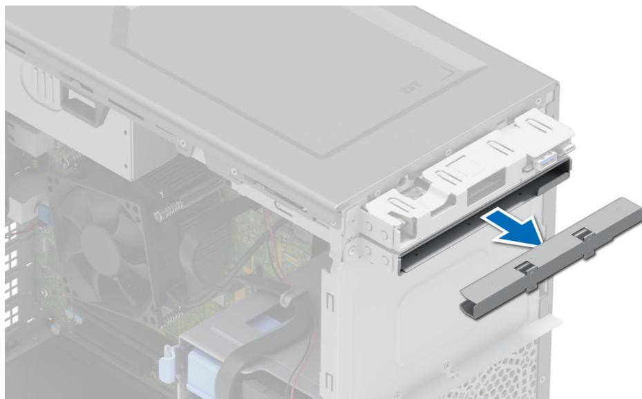
Figure 23. Retrait de la plaque de recouvrement du lecteur optique installée dans le bâti du lecteur optique
