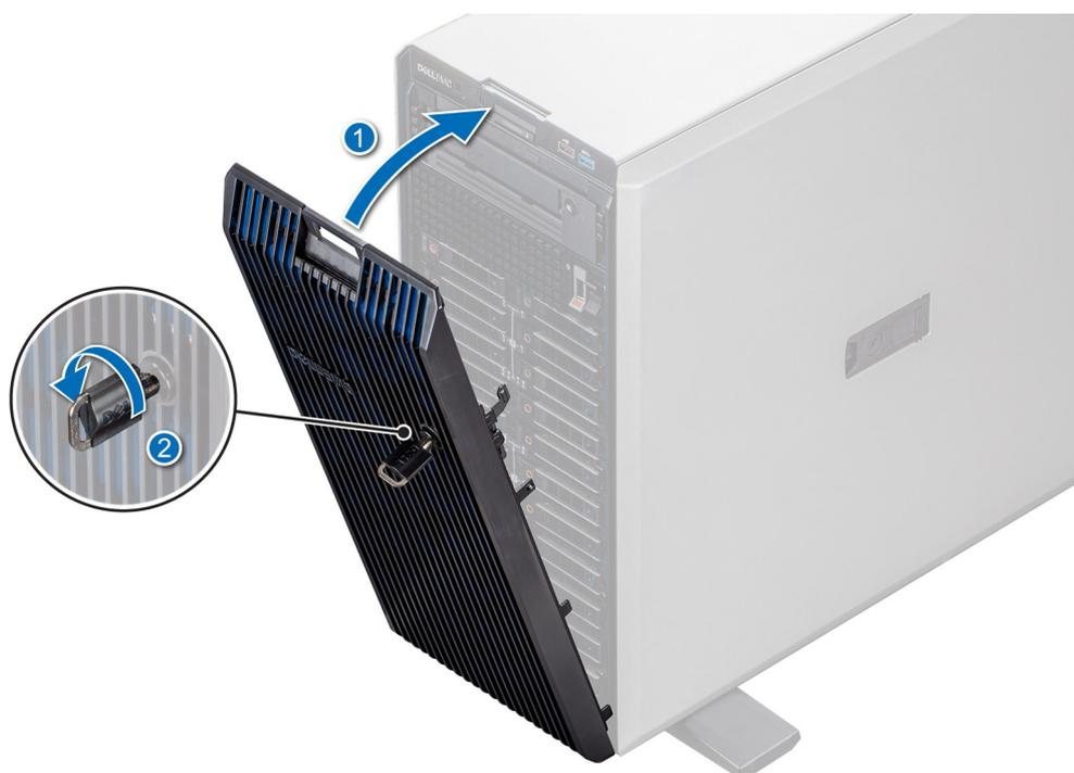
Figure 28. Installation du panneau avant
