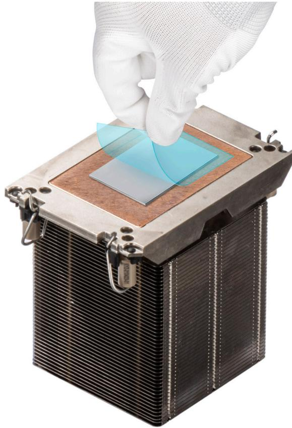
Figure 149. Retrait du film protecteur du matériau d'interface thermique (TIM)
