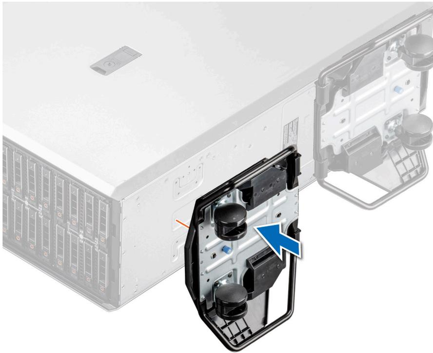
Figure 32. Installation des roulettes
