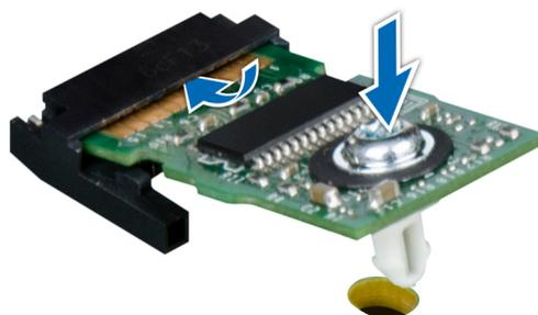
Figure 180. Installation du module TPM
