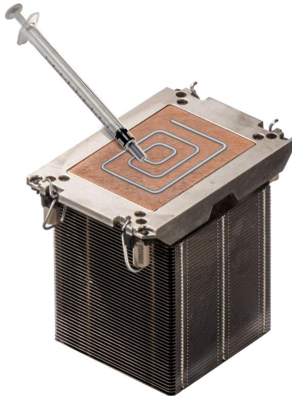
**Figure 148. Application de graisse thermique**
