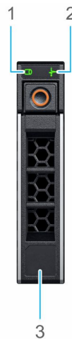
Ilustración 185. Indicadores de unidad en el backplane de bandeja de unidad intermedia y la unidad
