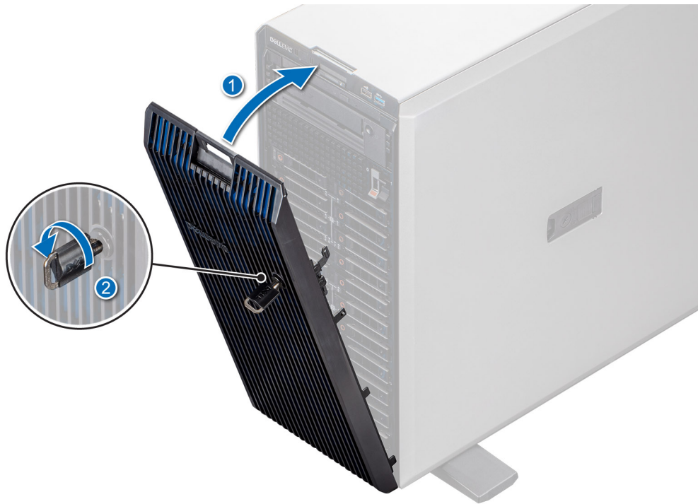
Ilustración 26. Instalación del bisel frontal
