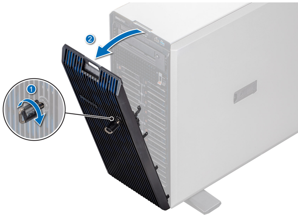
Ilustración 25. Extracción del bisel frontal
