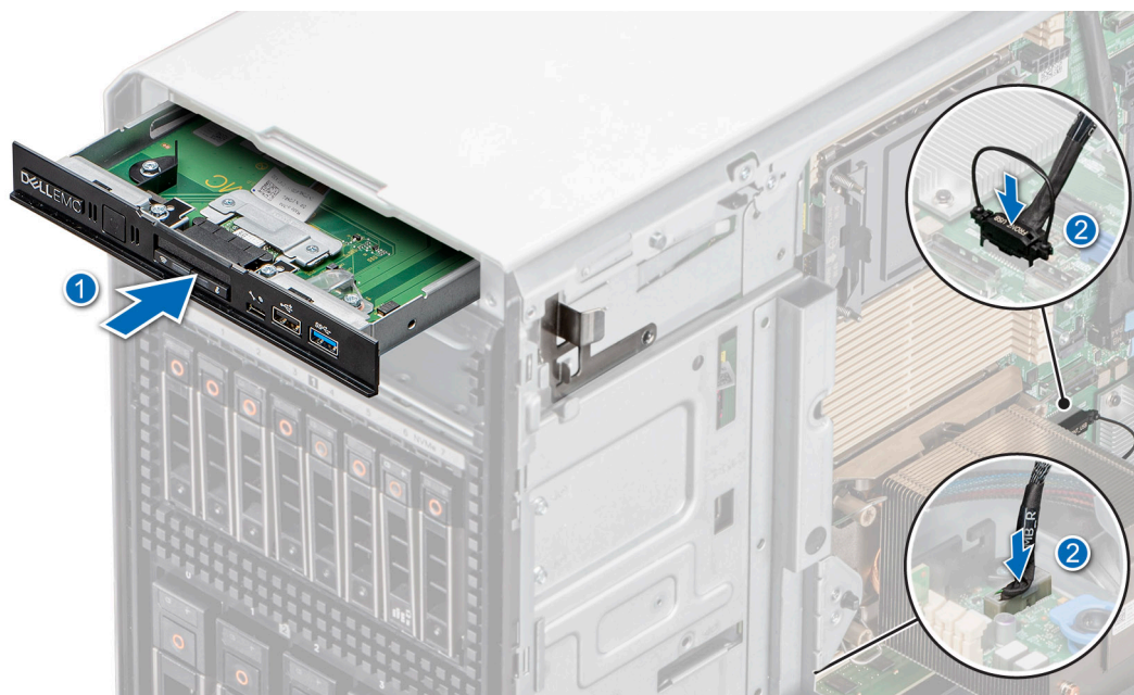
Ilustración 104. Instalación del módulo de I/O frontal para la configuración de gama superior
