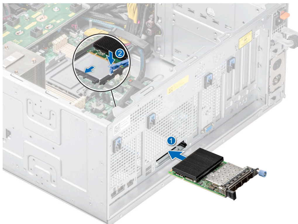
Ilustración 155. Instalación de la tarjeta OCP
