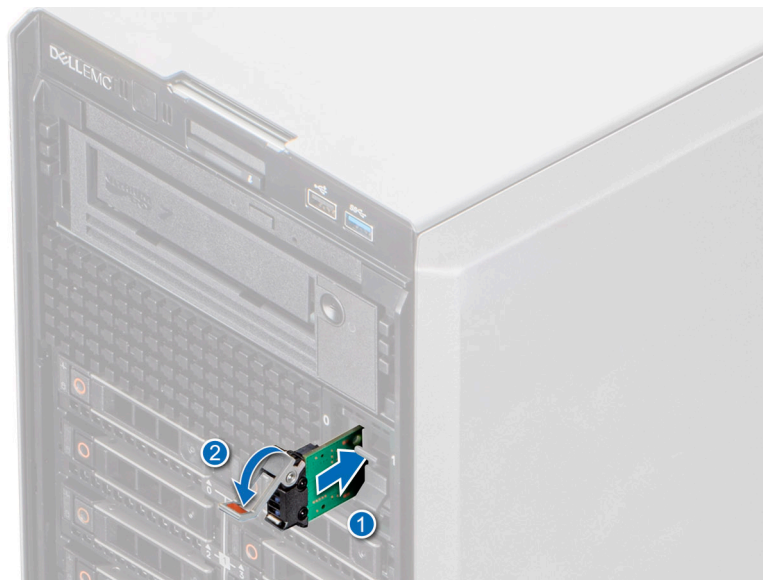
Ilustración 119. Instalación del portatarjetas de tarjeta del módulo S2 de BOSS
