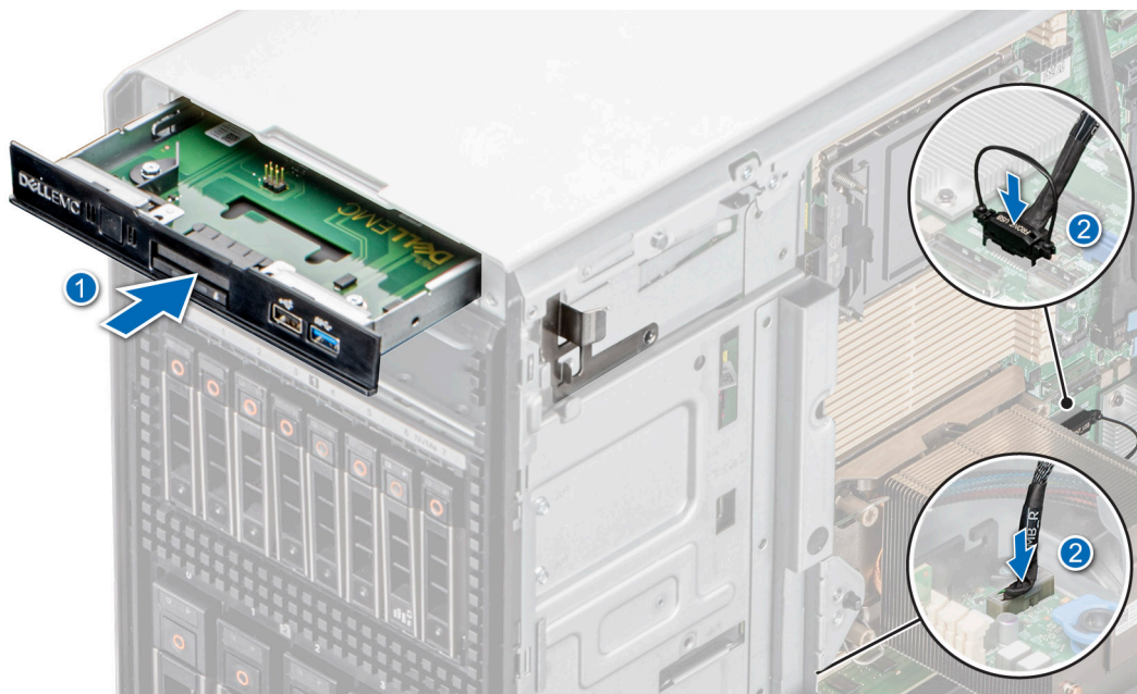
Ilustración 103. Instalación del módulo de I/O frontal para la configuración básica
