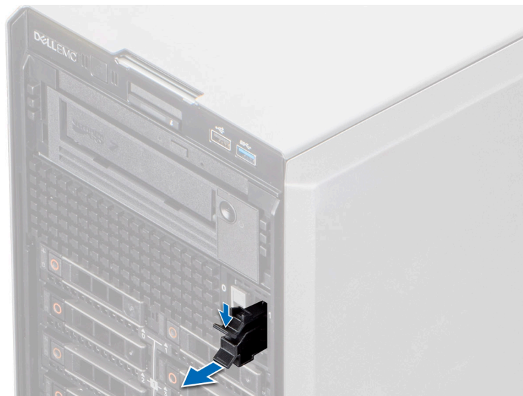
Ilustración 117. Extracción del soporte de tarjeta de Boot Optimized Storage Subsystem S2 de relleno
