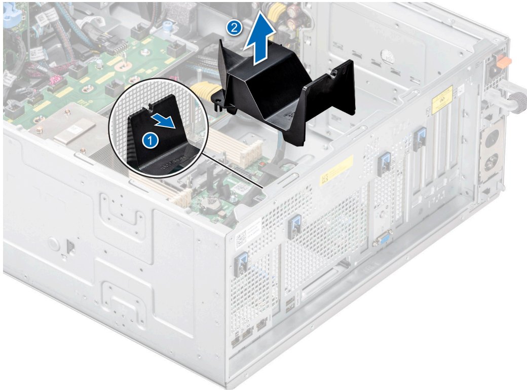
Ilustración 151. Extracción de la cubierta para flujo de aire de OCP
