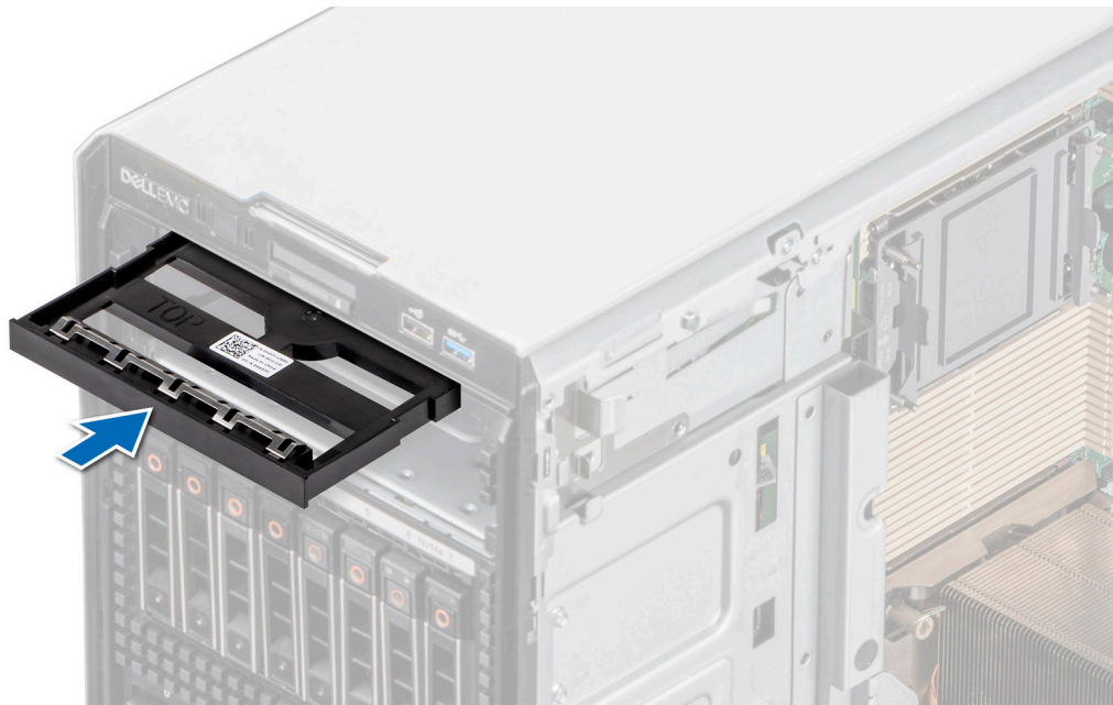
Ilustración 94. Instalación de la unidad óptica de relleno
