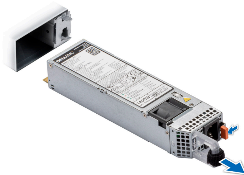
Ilustración 169. Extracción de una fuente de alimentación de 60 mm
