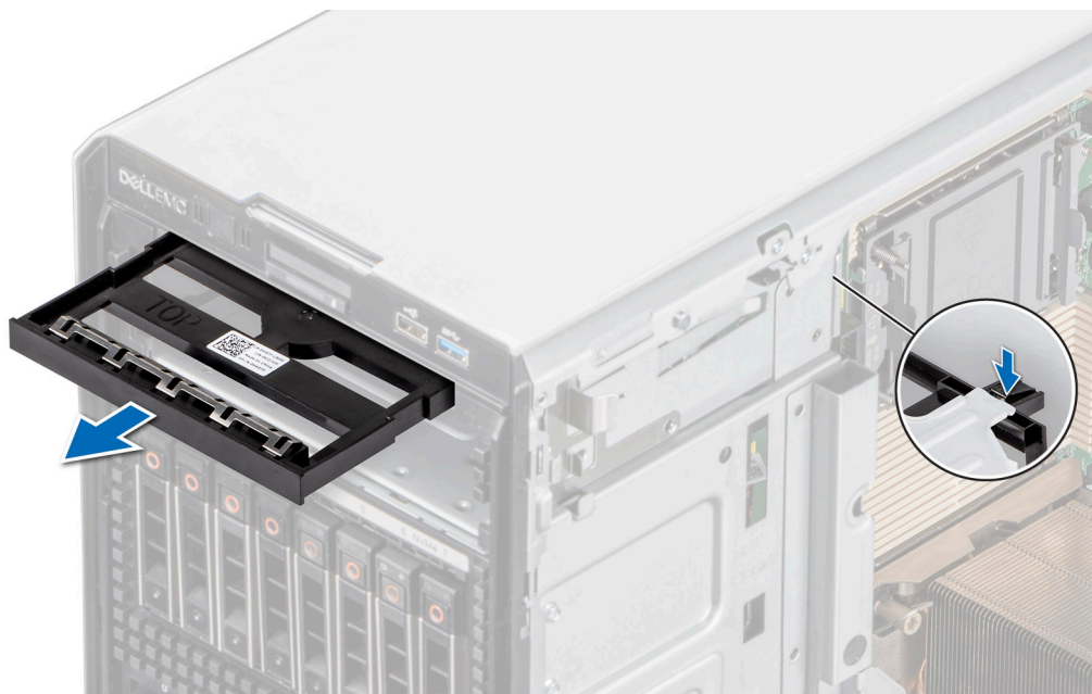
Ilustración 95. Extracción de la unidad óptica de relleno
