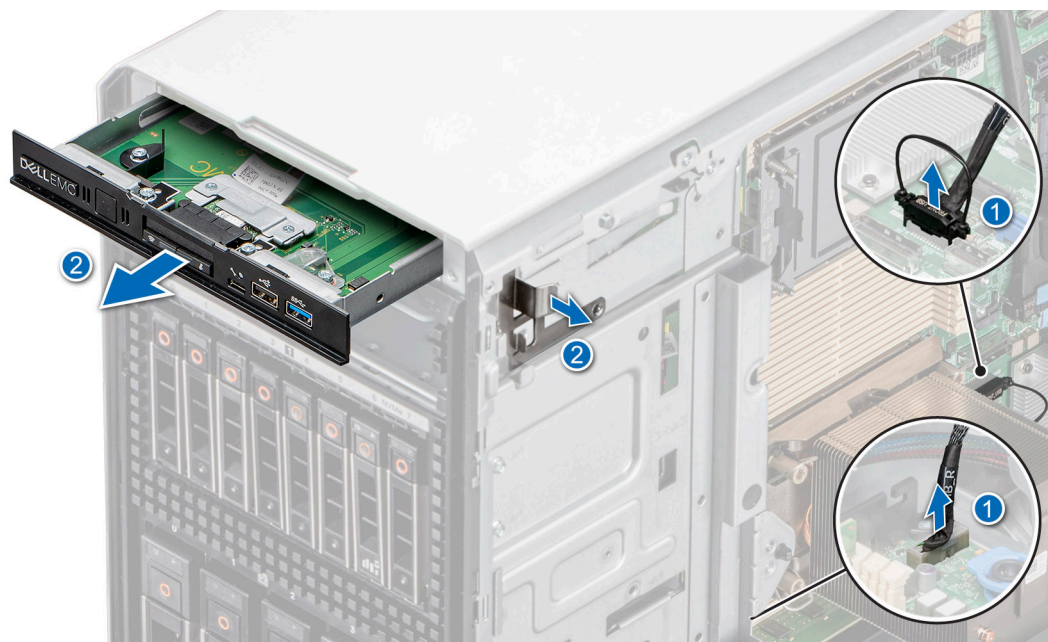
Ilustración 104. Extracción del módulo de I/O frontal para la configuración de gama superior
