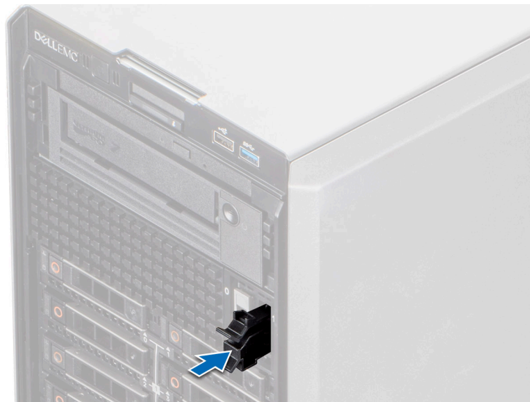
Ilustración 117. Instalación del soporte de tarjetas de relleno de Boot Optimized Storage Subsystem S2
