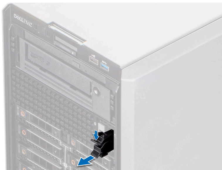
Ilustración 118. Extracción del soporte de tarjeta de Boot Optimized Storage Subsystem S2 de relleno
