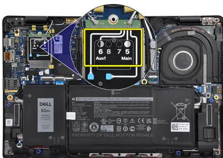
2. Allentare la singola vite (M2x2.5) di fissaggio e rimuovere la staffa della scheda WWAN.
