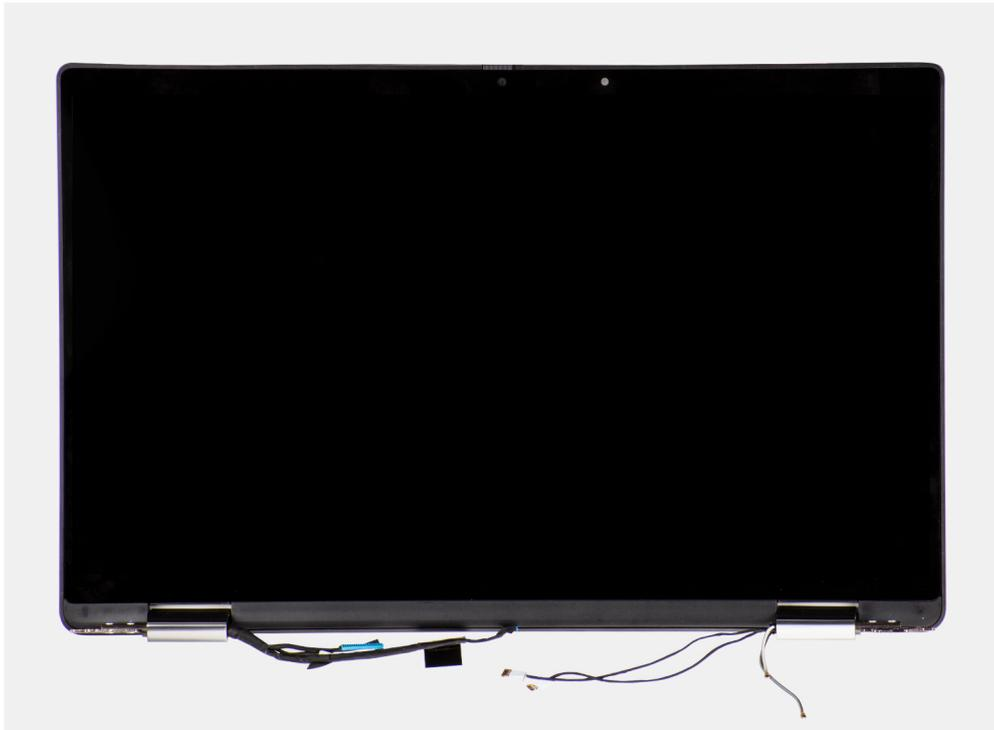
Figura 1. Gruppo del display con cavi dell'antenna
