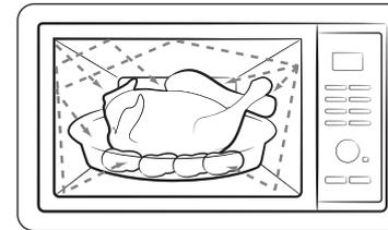
1. Le microonde generate dal magnetron vengono riflesse all'interno della cavità del forno e distribuite uniformemente, man mano che gli alimenti ruotano sul piatto girevole. Ciò permette di cuocere gli alimenti in modo uniforme.
