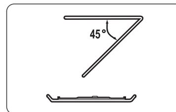
Per pulire la parte superiore del vano di cottura, abbassare di 45° l'elemento riscaldante superiore, come illustrato. Ciò consente di pulire l'area superiore. Al termine, riposizionare l'elemento riscaldante superiore.
