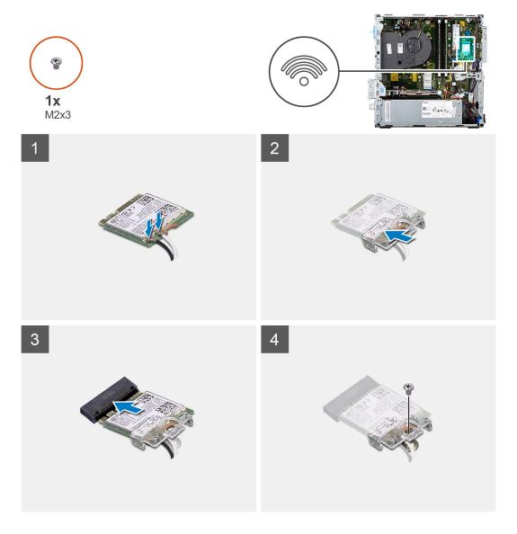
Verbinden Sie die Antennenkabel mit der WLAN-Karte.
