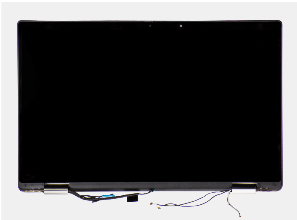
Figura1. Conjunto do ecrã com cabos da antena
