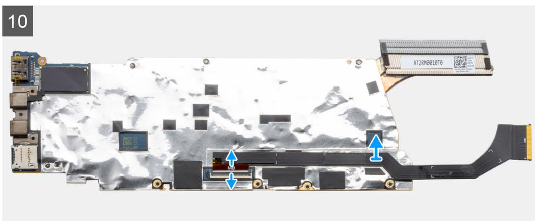
**NOTA:** As placas de sistema de substituição são pré-montadas com um dissipador de calor. Não retire o dissipador de calor da placa de sistema. A placa de sistema pode ser substituída em conjunto com o dissipador de calor anexado.
