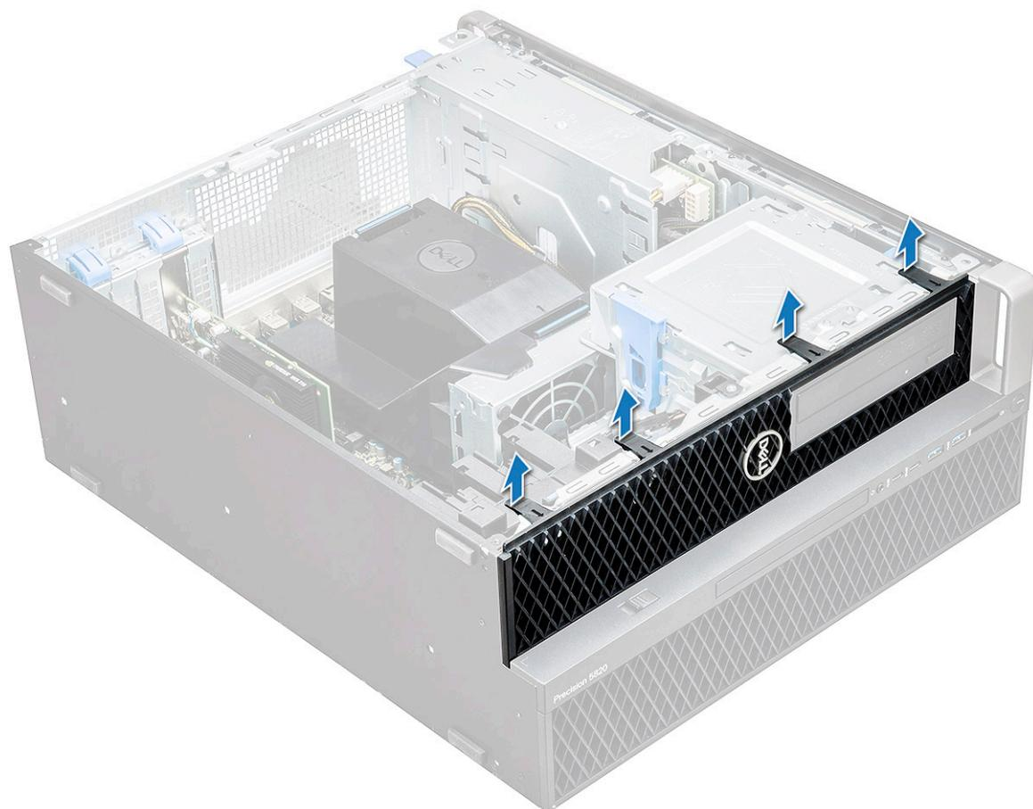
b. Gire la cubierta hacia adelante y levante la cubierta frontal para extraerla del sistema.
