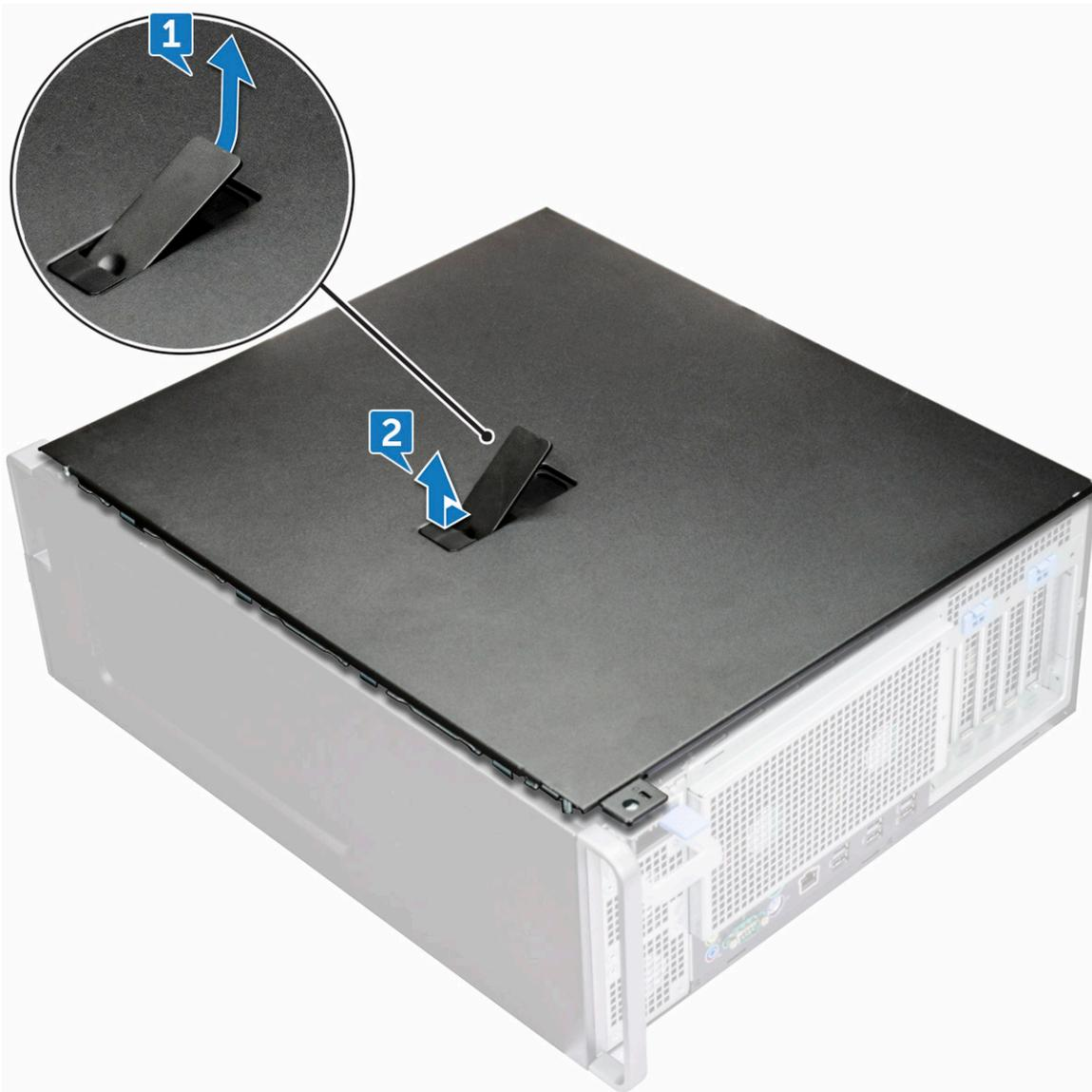
5. Levante la cubierta para extraerla del sistema.
