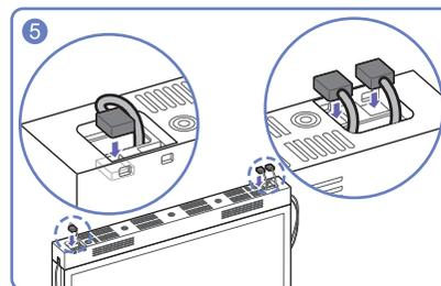
Positionnez fermement le câble IR externe et le capteur de lumière ambiante externe à l'endroit spécifié.
