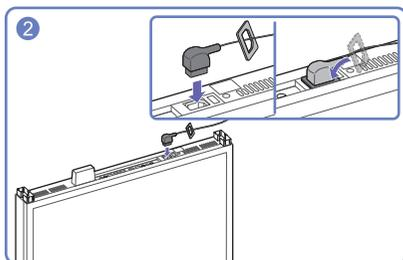
Insérez le cordon d'alimentation dans le caoutchouc pour l'entrée (IN) d'alimentation et branchez le cordon d'alimentation.
