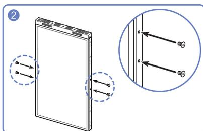
Remplacez les vis dans les trous de vis et fixez-les.
