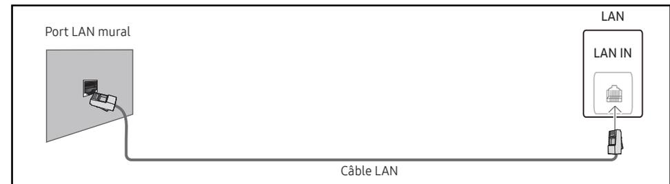
Si vous disposez d'un réseau dynamique, vous devriez utiliser un modem ADSL ou un routeur qui prend en charge le protocole DHCP (Dynamic Host Configuration Protocol). Les modems et routeurs qui prennent en charge DHCP fournissent automatiquement les valeurs **Adresse IP**, **Masque ss-réseau**, **Passerelle** et les valeurs DNS nécessaires à votre produit pour accéder à Internet ; vous n'avez donc pas à les entrer manuellement. La plupart des réseaux domestiques sont des réseaux dynamiques.
