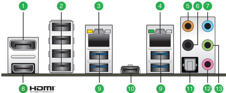
1. **DisplayPort IN-Anschluss.** Dieser Anschluss dient der Grafikkartensignaleingabe, wozu eine Verbindung mit einer zusätzlichen Grafikkarte über ein DisplayPort-Kabel erforderlich ist.
