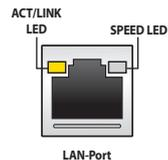
4. **2,5 G Ethernet-Anschluss.** Dieser Anschluss erlaubt eine 2,5 Gb/s Ethernet-Verbindung zu einem Local Area Network (LAN) mittels eines Netzwerk-Hubs. In der Tabelle auf der nächsten Seite finden Sie die LED-Anzeigen für den Ethernet-Anschluss.
