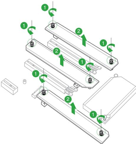
3. Installieren Sie Ihr M.2 in Ihrem M.2 Steckplatz. Die Schritte können bei der Installation von M.2 verschiedener Länge unterschiedlich sein. Bitte geben Sie auf die verschiedenen Typen und deren Installationschritte unten acht:
