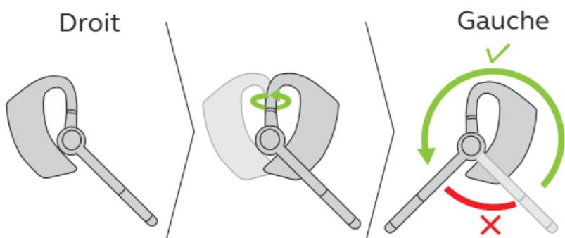
Pour changer d'oreille, faites pivoter le microphone horizontalement vers l'autre côté. Puis orientez le microphone vers le haut de l'autre côté afin de le diriger vers votre bouche.
