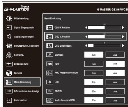
Drücken Sie die Taste Menu und schließlich die ◀ Taste, um die Bildschirmanzeigefunktion zu schließen. Alle Änderungen werden im Speicher gespeichert.
