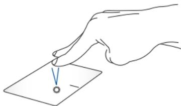
Toque con dos dedos en el panel táctil para simular la función de clic derecho.
