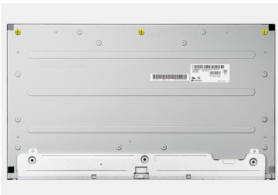
Die Abbildung zeigt die Rückseite eines Displays. Auf der Oberfläche sind vier gelbe Pluszeichen (+) markiert, die die Positionen für Madenschrauben an den Ecken des Displays anzeigen. In der Mitte befindet sich ein Barcode-Label mit der Aufschrift 'LCD Display' und 'MADE IN CHINA'. Die Display-Platte ist an einer Halterung befestigt, die an der Unterseite des Computers angeschlossen ist. |
