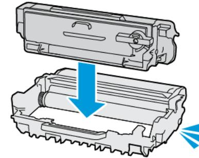
7. Réinsérez le module d'impression.
