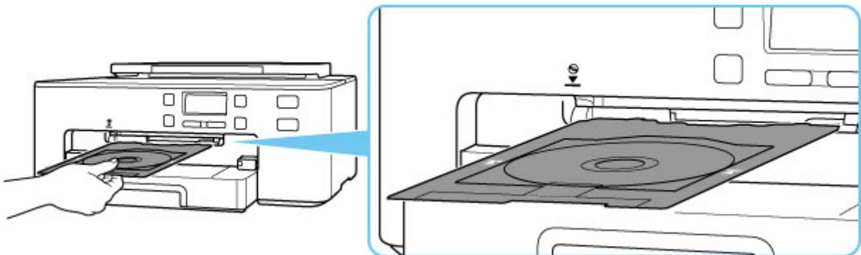
5. Inserire il vassoio multiuso diritto in orizzontale fino a che la freccia (↕) sulla guida vassoio multiuso non risulti all'incirca allineata con la freccia (▲) sul vassoio multiuso.
