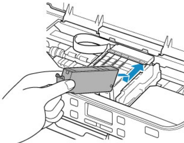
**8. Premere sulla parte superiore del serbatoio d'inchiostro finché il serbatoio d'inchiostro non scatta in posizione.**
