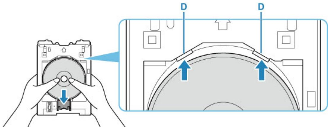
4. Posizionare il vassoio multiuso sulla guida vassoio multiuso.
