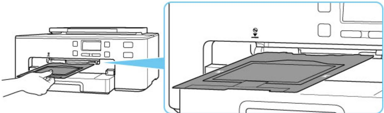
5. Inserire il vassoio multiuso dritto in orizzontale fino a che la freccia (▼) sulla guida vassoio multiuso non risulti all'incirca allineata con la freccia (▲) sul vassoio multiuso.
