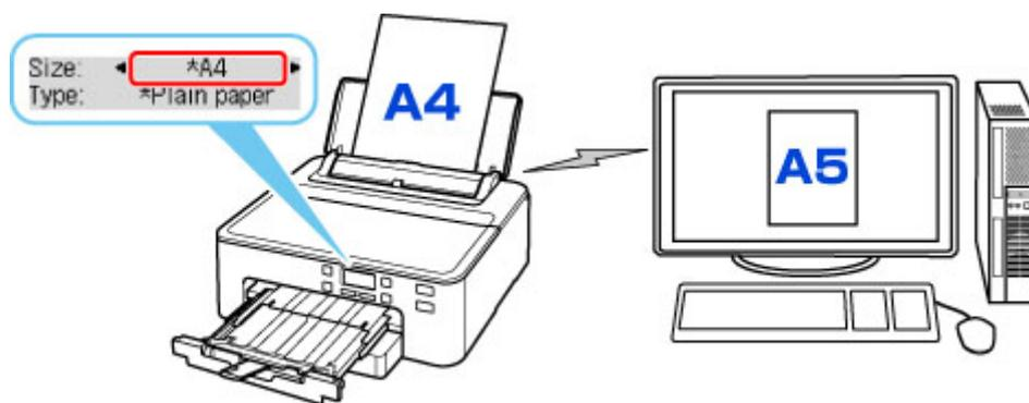
Quando si avvia la stampa, **Formato o tipo di carta caricata diverso dalle impostazioni (Size or type of loaded paper is different from the settings)** viene visualizzato sul display LCD.
