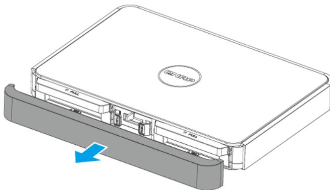
3. Enlevez un plateau de disque en appuyant simultanément sur le loquet et en tirant le plateau.
