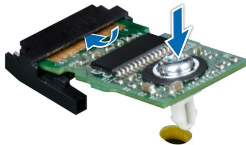
Ilustración 130. Instalación del TPM
