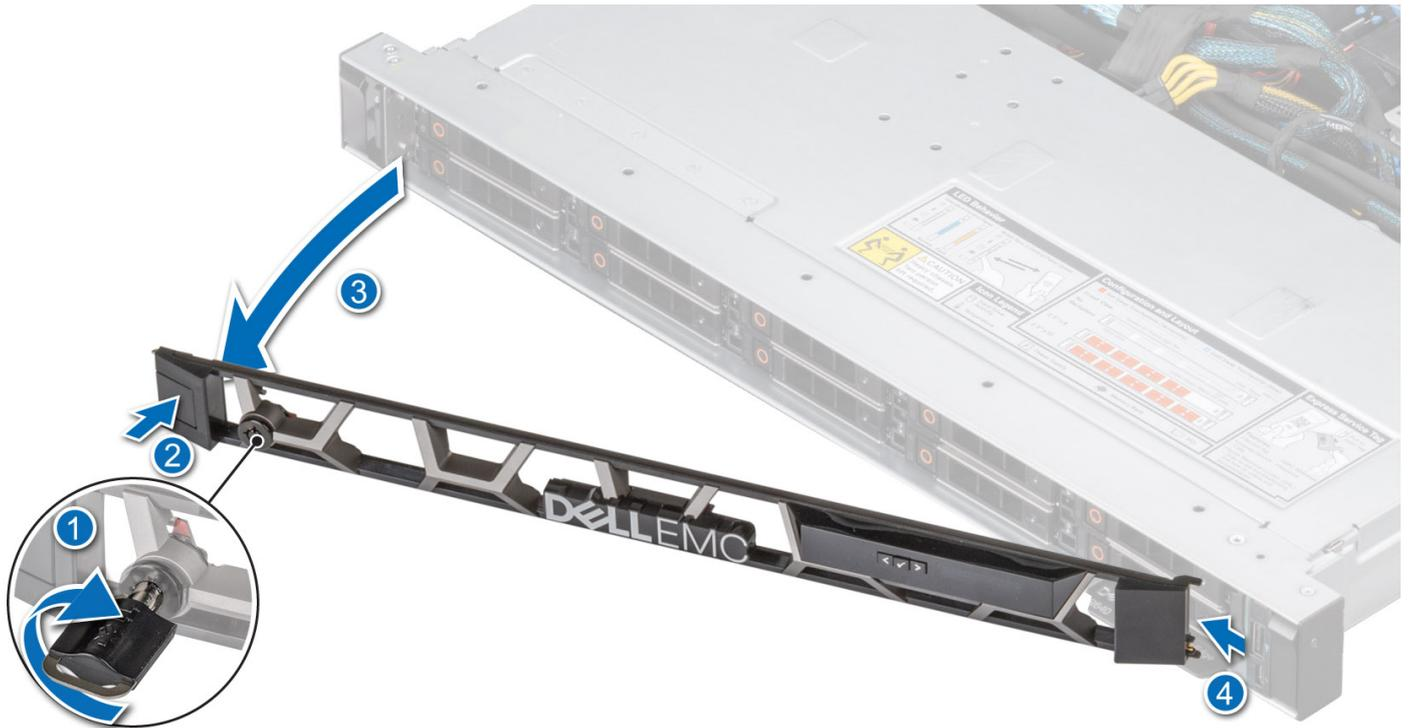
**Ilustración 24. Extracción del bisel frontal con el panel LCD**
