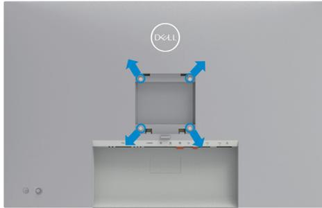
**NOTA: Utilize parafusos M4 de 10 mm para fixar o monitor ao kit de montagem em parede.**
