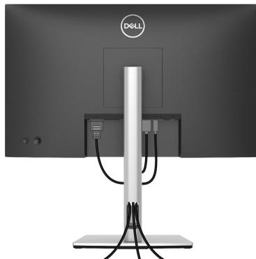
Nachdem Sie sämtliche erforderlichen Kabelverbindungen an Monitor und Computer hergestellt haben (siehe [Monitor anschließen](#)), führen Sie die Kabel wie oben gezeigt ordentlich durch den Kabelschacht.
