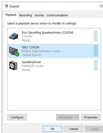
Wenn das USB Kabel und das HDMI oder DP Kabel vom Monitor an den Computer angeschlossen sind, werden zwei Audiopfade mit den Bezeichnungen **DELL C2423H/C2723H** und **Echo Cancelling Speakerphone (C2423H/C2723H)** vom Monitor in den **Sound** Einstellungen angezeigt. Der **DELL C2423H/C2723H** Monitor wird Optionen für die zwei vom Monitor unterstützten Audiopfade anzeigen.
