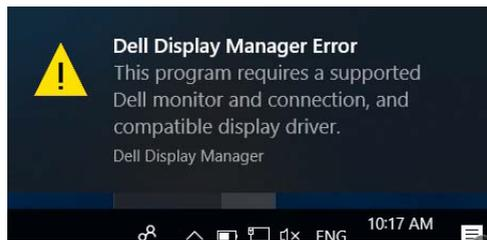
Tenha em conta que o DDM só é compatível com monitores da marca Dell. Se utiliza monitores de outros fabricantes, não serão compatíveis com o DDM.
