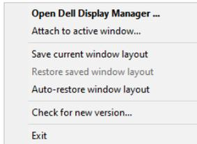
Se seleccionar **“Auto-restore window layout (Restaurar automaticamente o layout das janelas)”**, as posições das janelas das suas aplicações são rastreados e memorizados pelo DDM. O DDM restaura automaticamente as posições originais das janelas das aplicações, quando volta a ligar o seu computador ao(s) monitor(es).
