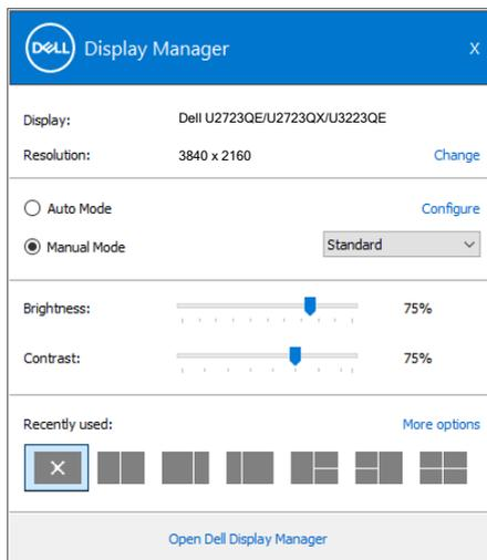
A caixa de diálogo **Quick Settings (Configurações Rápidas)** também dá acesso à interface de utilizador avançado do Dell Display Manager que é utilizada para ajustar as funções básicas, configurar o modo automático e aceder a outras funcionalidades.
