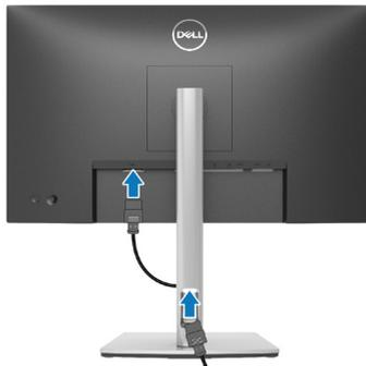
3. Conecte el cable DisplayPort, HDMI, USB-C (C-C) o USB-C (C-A) desde el monitor al equipo.
