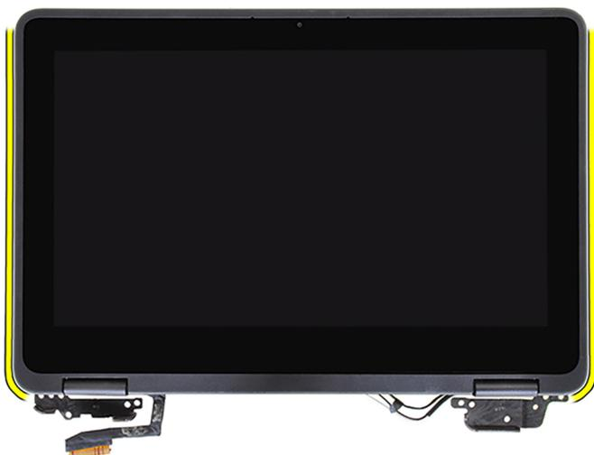
**ATTENZIONE:** Facendo leva dal bordo inferiore del pannello si rischia di danneggiare i componenti vicino alla parte inferiore del gruppo del display.
