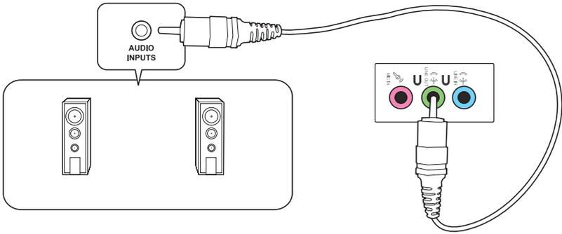
**Collegamento di altoparlanti in configurazione 4**
