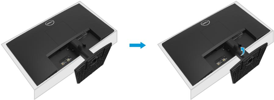
2. a. Drücken Sie mit einem langen, dünnen Schraubendreher auf den Schnellfreigabehebel in einem Loch direkt über dem Ständer.
