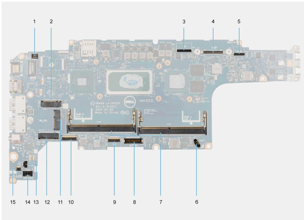
**Abbildung 2. Systemplatinenanschlüsse**
