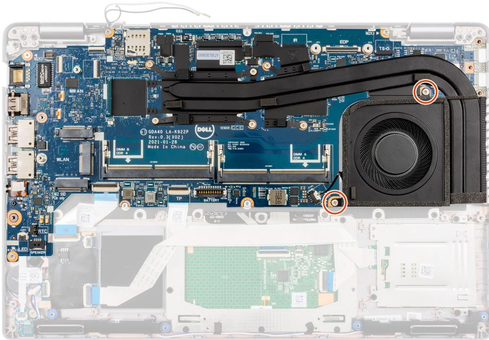
**i ANMERKUNG:** Bei Modellen, die mit einem Fingerabdruckleser ausgeliefert werden, trennen Sie das Kabel des Fingerabdrucklesers vom Anschluss auf der Hauptplatine, bevor Sie die Hauptplatine aus der Handauflagenbaugruppe und Tastaturbaugruppe entfernen.
