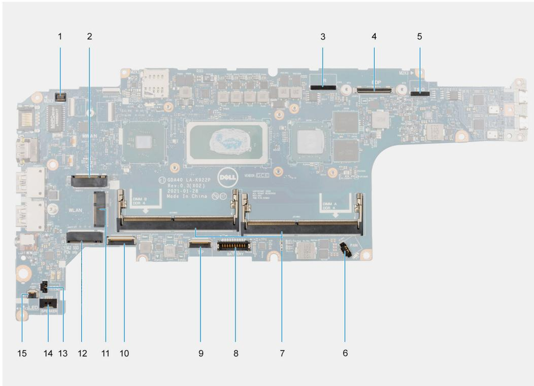
**Abbildung 1. Systemplattenanschlüsse**
