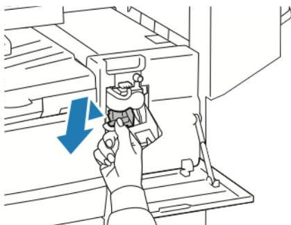
5. Controllare se all'interno della stazione di finitura sono presenti punti metallici, quindi rimuoverli.
