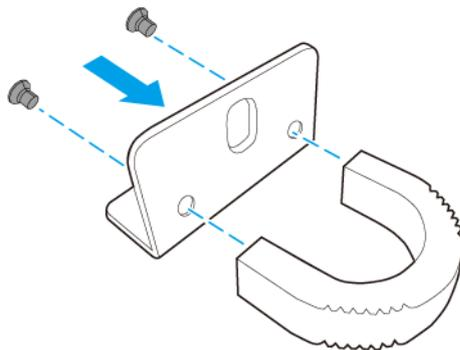
3. Installieren Sie die Winkelhalterung am Gerät.
