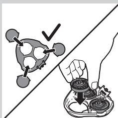
*Note: Assicuratevi che le sporgenze delle testine di rasatura si inseriscano perfettamente nelle rientranze.*
