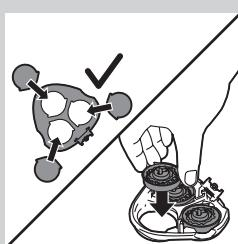
*Nota: Asegúrese de que los salientes de los cabezales de afeitado encajan exactamente en las ranuras.*
