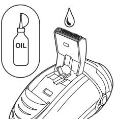
*İpucu: Optimum düzeltme performansı için düzelticinin dişlerini altı ayda bir, bir damla dikiş makinesi yağıyla yağlayın.*
