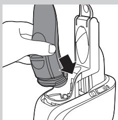
**4** Duw de vergrendelhendel helemaal omlaag om het scheerapparaat vast te zetten.
