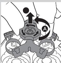
**4** Drehen Sie die Verriegelung gegen den Uhrzeigersinn (A), und entnehmen Sie den Scherkopfhalter (B).
