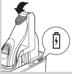
► Når batteriet er fulladet, lyser batterisymbolet på Jet Clean-systemet kontinuerlig.
