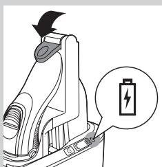
► Quando la batteria è completamente carica, il simbolo della batteria sul sistema Jet Clean si accende in maniera continua.
