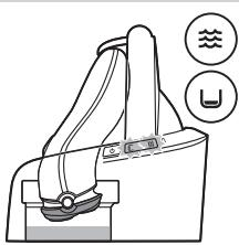
Hinweis: Sinkt der Füllstand unter das vorgegebene Minimum, blinken Reinigungs- und Flüssigkeitsstandsимвол, und die Rasiererhalterung kehrt in ihre Ausgangsposition zurück.
