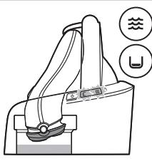
**Opmerking:** Wanneer het vloeistofniveau zakt tot onder het minimumniveau, beginnen het reinigingssymbool en het 'weinig vloeistof'-symbool met tussenpozen te knipperen en keert de scheerapparaathouder terug naar de beginstand.
