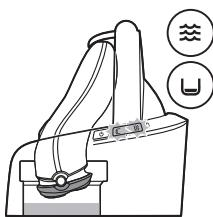
**Remarque :** Lorsque le niveau du liquide est trop bas, le symbole de nettoyage et le symbole « niveau de liquide bas » clignotent et le support du rasoir reprend sa position initiale.
