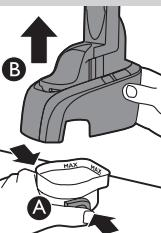
**2** Trykk på utløserknappene på begge sider av Jet Clean-systemet (A) samtidig. Løft deretter Jet Clean-systemet av rengjøringskammeret (B).
