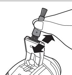
*Tip: Smeer de tanden van de trimmer om de zes maanden met een druppeltje naaimachineolie voor een optimaal trimresultaat.*
