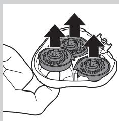
**5** Rimuovete e pulite una testina di rasatura alla volta. Ogni testina di rasatura è composta da una lama e un paralama.
