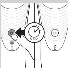
**9** Håll på/av-knappen nedtryckt i 5 sekunder så återställs bytespåminnelsen på rakapparaten. Den orangea lampan släcks.
