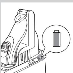
**5** Pour retirer le rasoir du système de nettoyage Jet Clean, soulevez le levier de verrouillage au maximum et retirez le rasoir.
