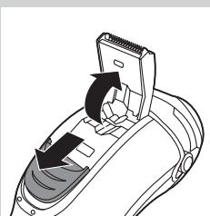
**3** Düzeltme işleminden sonra düzelticiyi ve tıraş makinesini kapatın.
