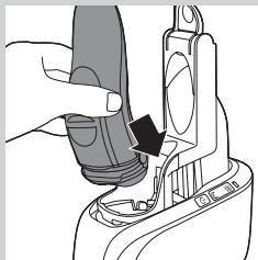
**4** Abbassate completamente la levetta di blocco per bloccare il rasoio in posizione.
