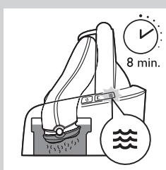
**Nota:** Se premir o botão ligar/desligar do sistema Jet Clean durante o programa de limpeza, este é interrompido e volta ao início. Neste caso, a intermitência da indicação de limpeza pára e o suporte da máquina de barbear volta à posição inicial. A máquina de barbear pode estar ainda molhada e suja, pois o programa de limpeza não foi concluído.
