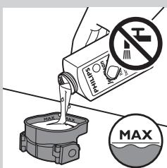
**5** Fyll rengöringsbehållaren med Jet Clean-lösning (HQ200) upp till MAX-nivån.
