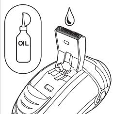
*Tip: Smør trimmerens tænder med en dråbe symaskineolie hver 6. måned for at bevare optimal trimmerfunktion.*
