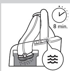
**Remarque :** Si vous appuyez sur le bouton marche/arrêt du système de nettoyage Jet Clean pendant le programme de nettoyage, le programme s'arrête, puis se réinitialise. Le symbole de nettoyage cesse de clignoter et le rasoir reprend sa position initiale. Il se peut que le rasoir soit encore humide et sale, car le programme de nettoyage n'a pas été exécuté jusqu'au bout.
