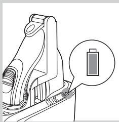
**5** Per rimuovere il rasoio dal sistema Jet Clean: spostate la levetta di blocco verso l'alto fino al suo arresto e rimuovete il rasoio.
