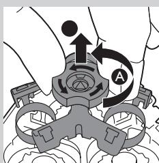
**4** Faites tourner le système de fixation dans le sens inverse des aiguilles d'une montre (A), puis retirez-le (B).
