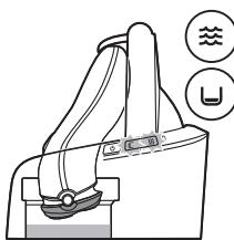
**Nota:** Quando il liquido scende sotto il livello minimo, il simbolo di lavaggio e quello di "livello basso di liquido detergente" iniziano a lampeggiare e il supporto si riporta in posizione iniziale
