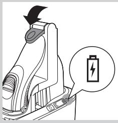
► Wanneer de accu helemaal opgeladen is, brandt het batterisymbool op het Jet Clean-systeem continu.
