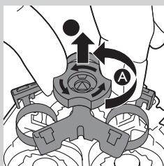
**4** Ruotate il sistema di bloccaggio in senso antiorario (A) e rimovete la struttura di supporto (B).
