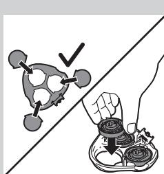
**Note:** Assicuratevi che le sporgenze delle testine di rasatura si inseriscano perfettamente nelle rientranze.
