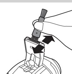
*Consiglio: Per ottenere prestazioni ottimali, lubrificate i dentini del rifinitore ogni sei mesi, utilizzando una goccia di olio per macchina da cucire.*
