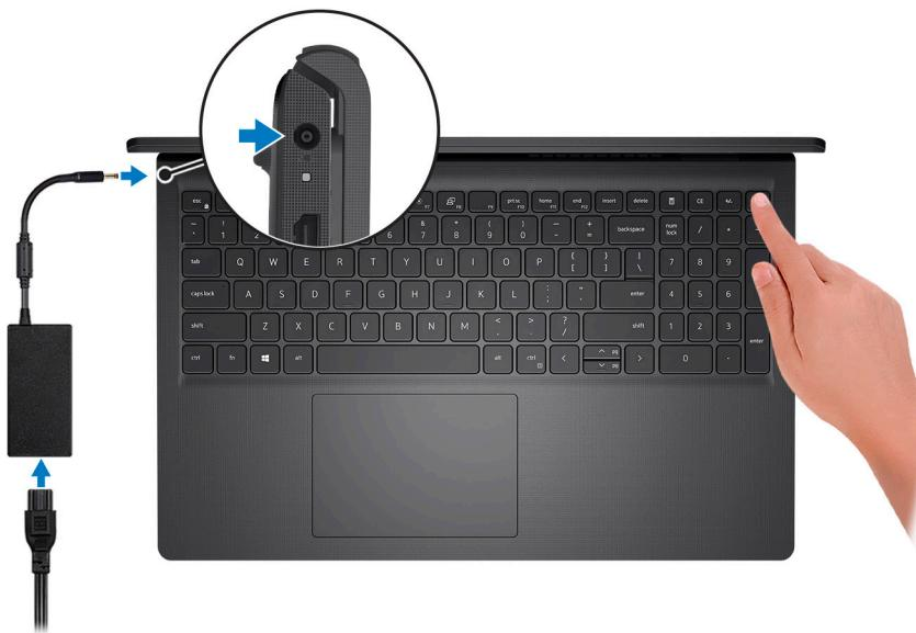
**i | NOTA:** Para conservar a carga da bateria, você pode colocá-la no modo de economia de energia. Conecte o adaptador de energia e pressione o botão liga/desliga para ligar o computador.
