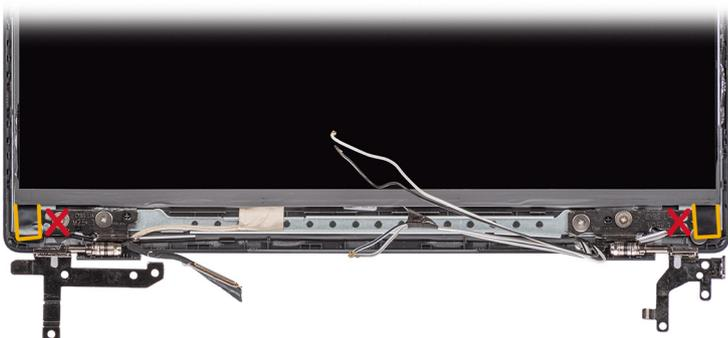
As imagens a seguir indicam a localização do painel de exibição e fornecem uma representação visual do procedimento de remoção.
