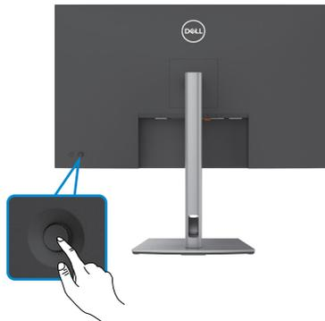
Para alterar os ajustes OSD através do controlo do joystick situado na extremidade traseira do
