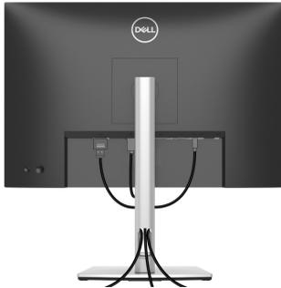
Después de conectar todos los cables necesarios al monitor y al PC (consulte [Conexión de su monitor](#) para conectar los cables), utilice la ranura de sujeción de cables para organizarlos correctamente tal y como se muestra arriba.
