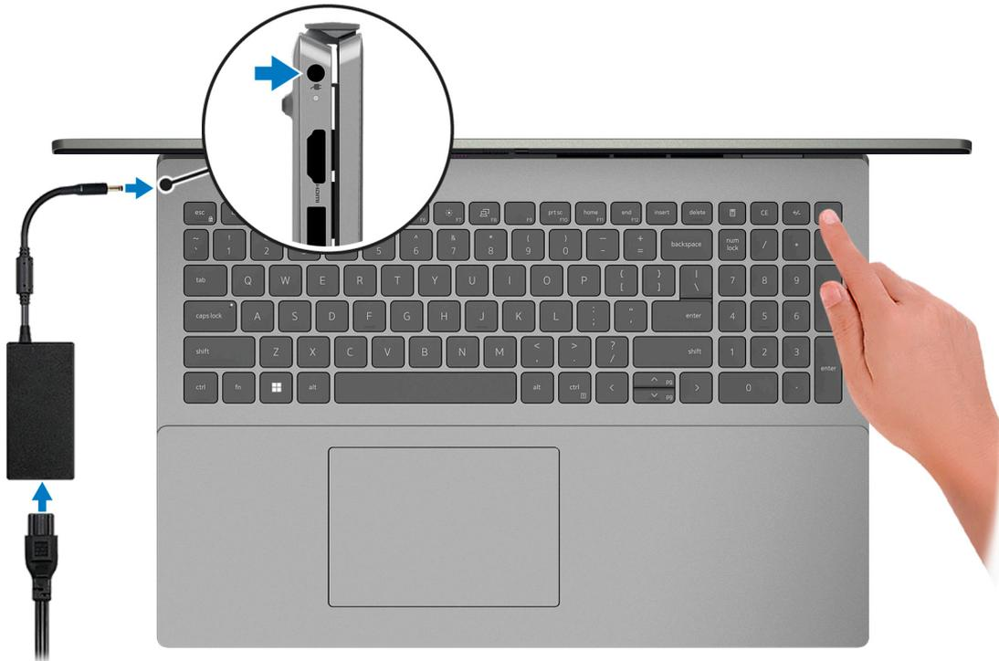
**NOTA:** Para conservar la energía de la batería, es posible que esta ingrese en modo de ahorro energético. Para encender el equipo, conecte el adaptador de alimentación y presione el botón de encendido.
