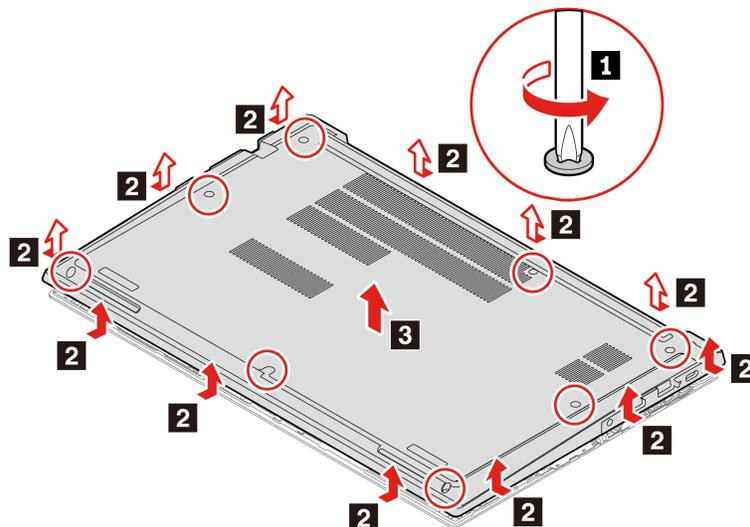
5. Installare il nuovo assieme del coperchio di base **1**. Accertarsi che i fermi dell'assieme del coperchio della base siano fissati sotto l'assieme del coperchio della base **2**. Stringere quindi le viti per fissare l'assieme del coperchio della base **3**.
