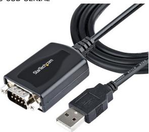
El adaptador de 1 puerto USB a Serie 1P3FPC-USB-SERIAL le permite añadir un puerto serie COM RS-232 DB9 a su ordenador portátil o de sobremesa, permitiéndole controlar y comunicarse con un dispositivo periférico serie.
