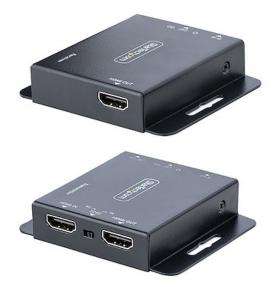
Cette rallonge HDMI® sur CAT6 vous permet de transmettre un signal audio vidéo HDMI® 4K 30Hz jusqu'à 40m, ou 70m pour les résolutions 1080p. Ce kit de conversion comprend à la fois l'émetteur et le récepteur pour une solution complète de bout en bout.
